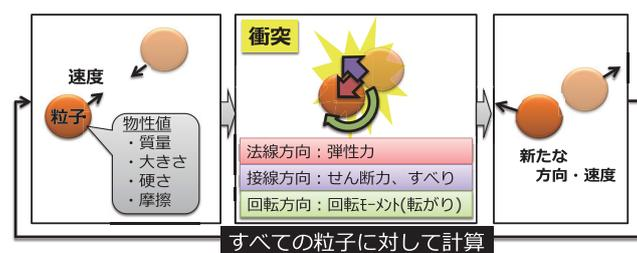
図1 個別要素法 (DEM) を用いた粉体粒子の挙動シミュレーションのアルゴリズム<sup>(1)</sup>
