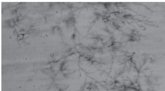
写真2 主絶縁体の破壊バス近傍に認められた方向不定の電気トリー（真綿状トリー） (1)
