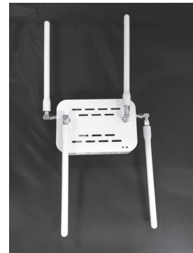
写真1 中継機外観写真
