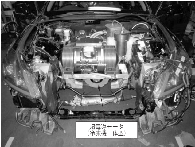
写真2 エンジンルームへの超電導モータ搭載状況
