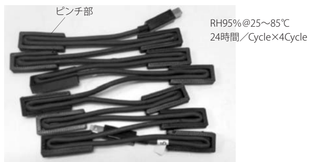
写真2 ケーブルピンチと湿熱の複合試験サンプル
