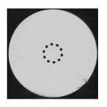
写真1 ファイバ断面構造
