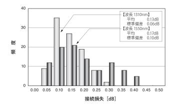
図6 SM-HAFパッチコードの挿入損失ヒストグラム
