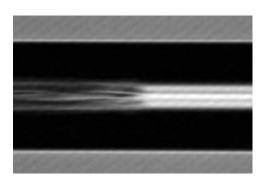
写真2 融着接続部近傍の側方写真
