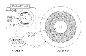
図7 SM-HAF ケーブル断面構造
