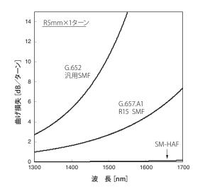
図2 半径5mm曲げにおける各光ファイバの曲げ損失の波長依存性
