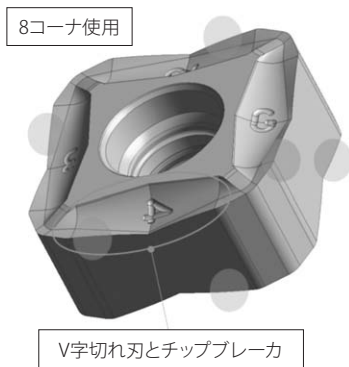
図2 DNX用チップのブレーカと切れ刃形状
