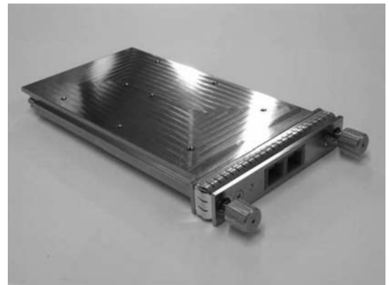
写真2 CFP光トランシーバの外観写真
