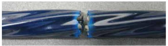
鋼線の破断直前まで被覆は追随し、その連続性は保たれています。鋼線破断後も、被覆は鋼線と一体となる挙動を示します。
