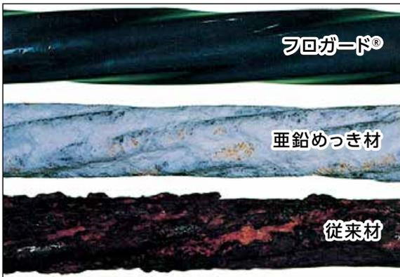
従来材(裸)、亜鉛めっき材と比較して卓越した耐食性を有しています。(塩水噴霧1,000時間後)
