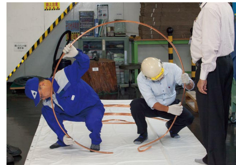
インド向けのトロリ線は、毎回、第三者機関による厳重な品質審査を経て出荷される
