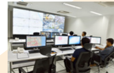
交通管制システム さまざまな交通情報を収集・解析し、信号機の制御や交通情報の提供を行うことで、安全で円滑な交通流を実現します。
